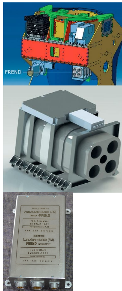
Фиг. 1. Горe - платформата на ЕкзоМарс с научните прибори; в средата - FREND с монтиран на него Люлин-МО; долу - външен вид на прибора „Люлин-МО“.
