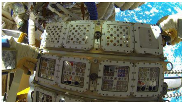
Фиг.4. Приборът R3DR се намира в горния десен ъгъл на платформата EXPOSE-R2, която е монтирана от руския космонавт Олег Артемиев извън руския модул „Звезда“ на МКС на 22 октомври 2014 г.
